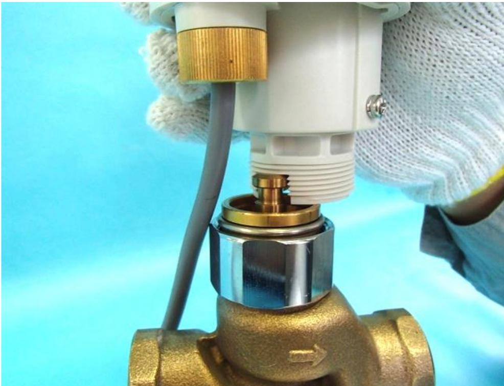
※駆動部(モーター)とピストン組品は管吊式の接続方法(一体ではない)ことから、現場状況によりピストン組品ごと引き上げる事が出来ない場合 にはグランドナットを外した後で駆動部(モーター)のみを外す事も出来ます。
