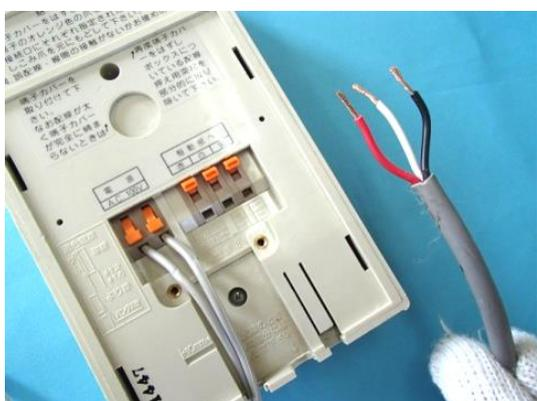
電源が ON になっている状態で、駆動部の接続コードの赤・白・黒の全てを操作盤から抜くと、点検ランプは点滅する。
