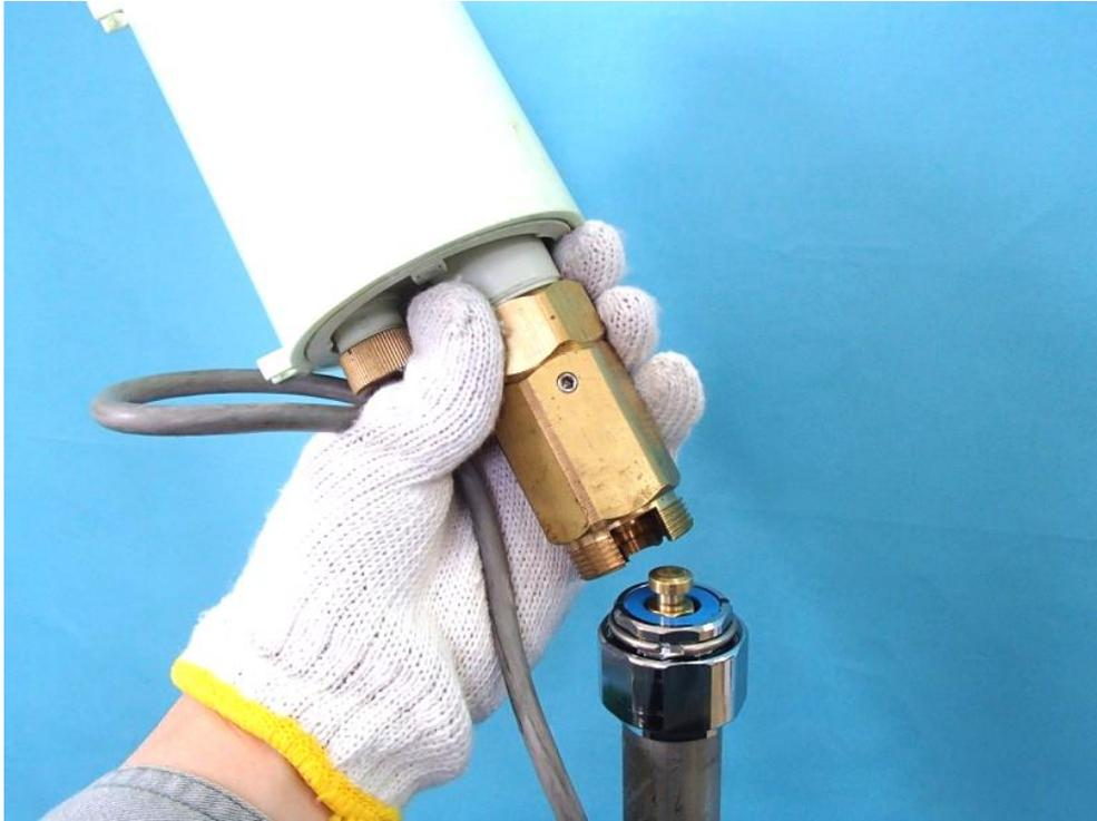
駆動部をバルブ側から取り外し、そのまま操作盤から操作を行います。
