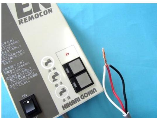
電源が ON になっている状態で、駆動部の接続コードの赤・白・黒、全て結ぶと、給水・水抜、何れの操作をしても点検ランプは点灯する。
