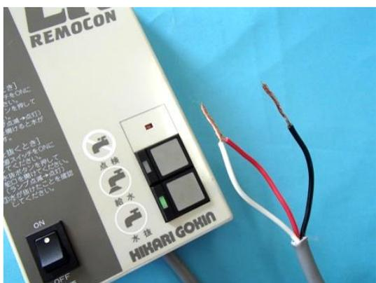
電源が ON になっている状態で、水抜ボタンを押してから駆動部の接続コードの赤線と白線を結ぶと、水抜ランプ点灯する。
