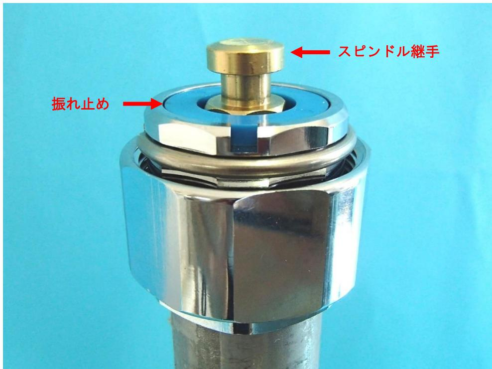
中シャフトを最後まで押し込んだ状態で、スピンドル継手のくびれ下部分と、振れ止め(青いリング)の高さが同一になる様に調整して下さい。
